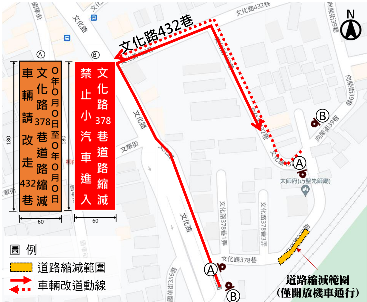
圖 3.4 文化路 378 巷道路縮減改道動線與牌面設置示意圖
