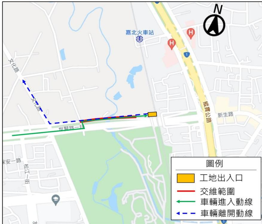
圖 3.4 施工機具進離場動線示意圖
