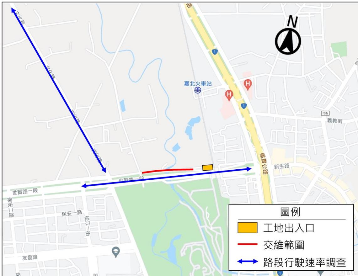
圖 2.3 施工便道周邊旅行速率調查路段示意圖
