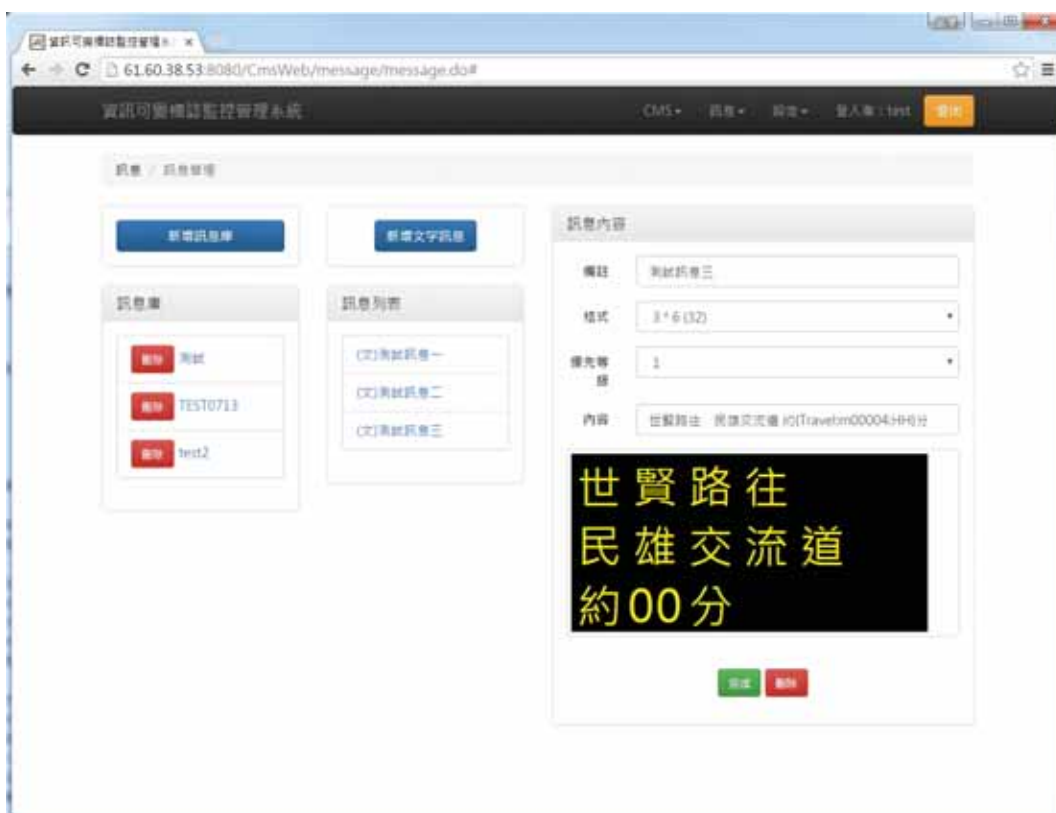
圖 4.2-12 CMS 連動旅行時間顯示功能操作畫面
