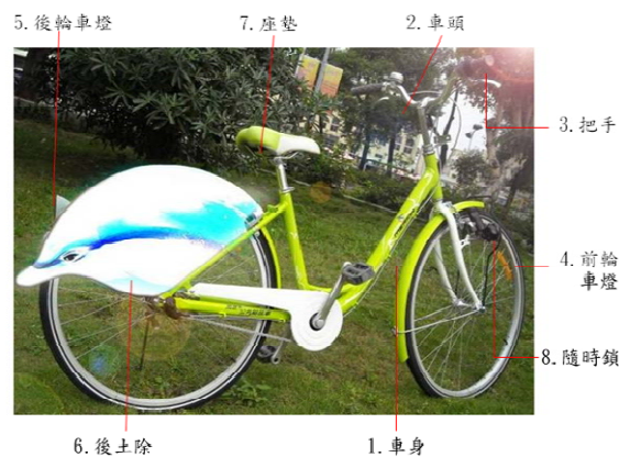
圖 5.14-1 高雄市公共自行車-C-Bike 車體示意圖
