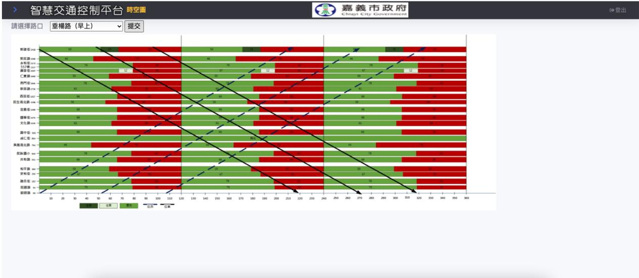
圖 5.5-11 交控系統納入時空圖選單路段查詢介面示意圖
