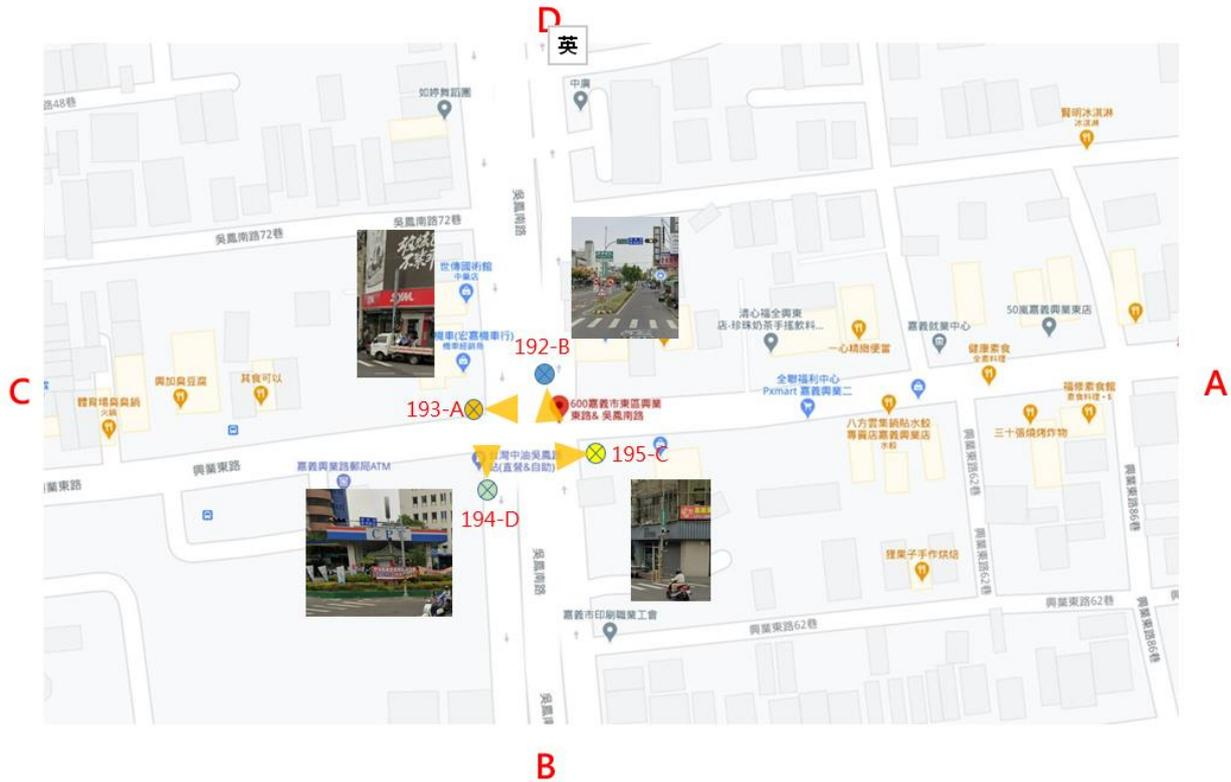
圖 5.4-6 AI 影像車流辨識設備 IPCAM 架設位置與偵測方向示意圖
