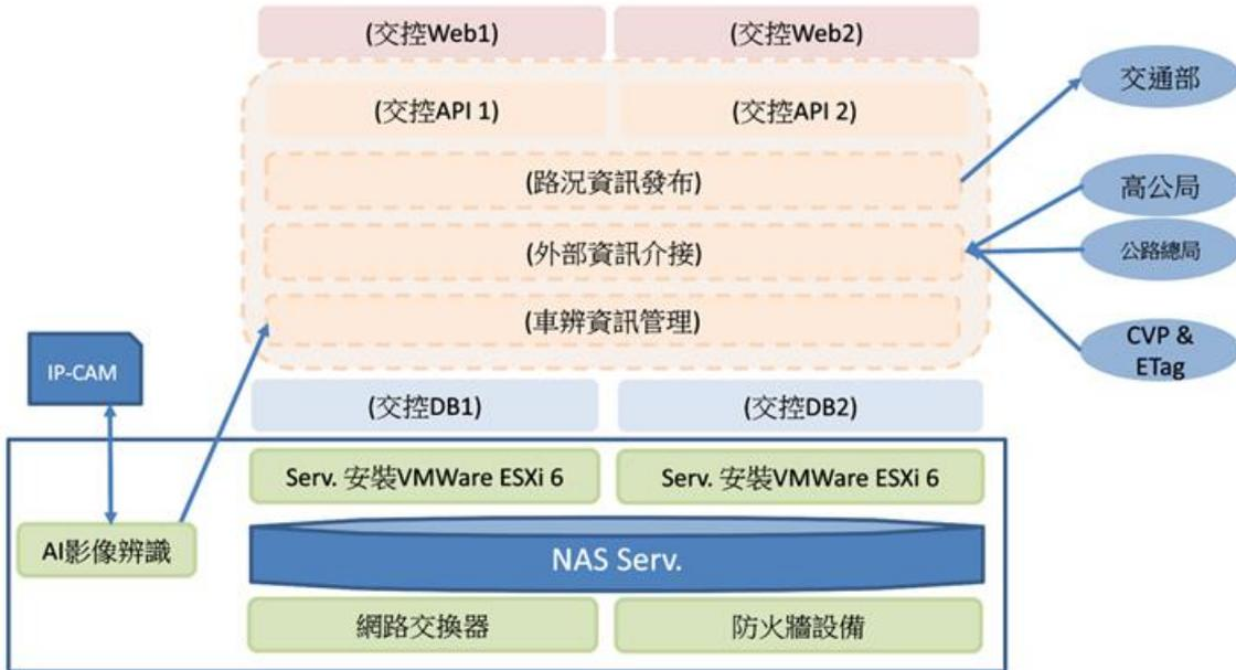
圖 5.2-1 智慧交控系統整合平台硬體模組架構示意圖
