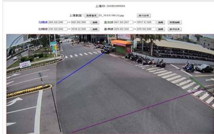
圖 5.4-4 車流偵測線系統功能設定示意圖
