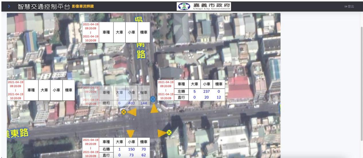
圖 5.4-8 智慧交控系統整合平台 AI 影像車流計數分析開發畫面圖
