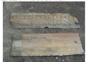
【圖 4-11-57】嘉義火車站第一月台天溝所用之銅皮材料。
