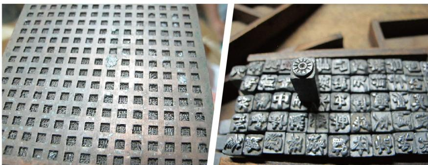
早期鑄作鉛字體的設備龐大，工廠規模自然得擴大。作業二十四小時，採三班制上工。現今豐益印刷廠內仍有七、八台鉛字鑄字機，都還可運作，羅老闆說明，首先將鉛條放入後頭的凹槽裡，用瓦斯加熱盛盤，溶解鉛條，由前段槽溝流出，一條銅模放入框架內，將溶液灌入銅模裡，產製一柱柱的鉛字。
