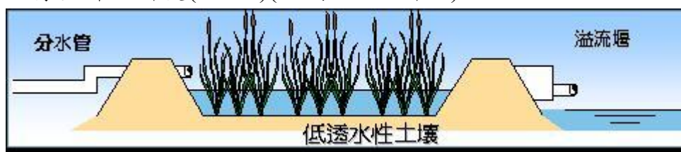
圖 6.1-3、濕地處理自然淨化法-自由水面系統示意圖
