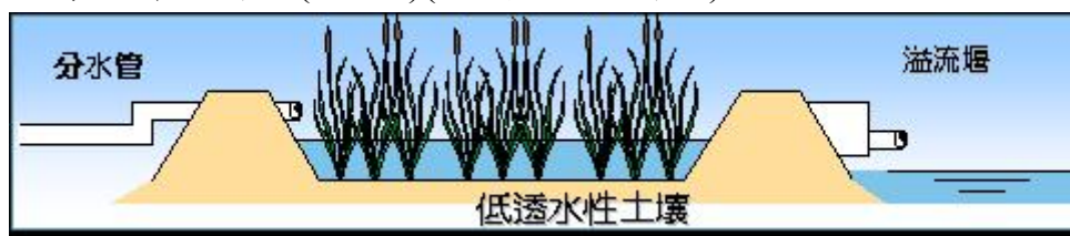
圖 5.1-3、濕地處理自然淨化法-自由水面系統示意圖
