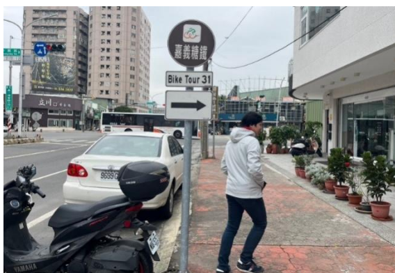
公車站牌下緣淨高不足2.1米
