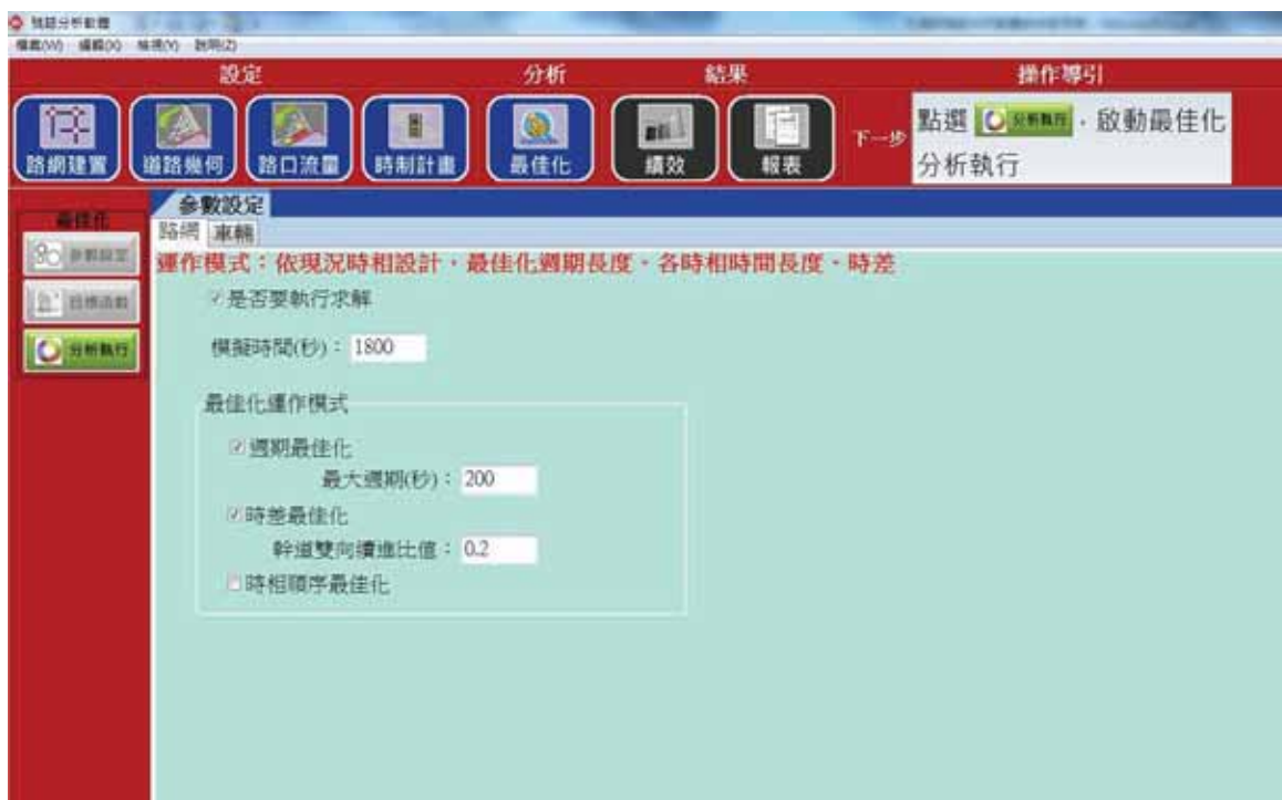
圖 3.1.5-5 交通部時制最佳化軟體使用限制-無法選取最佳化之目標函數
