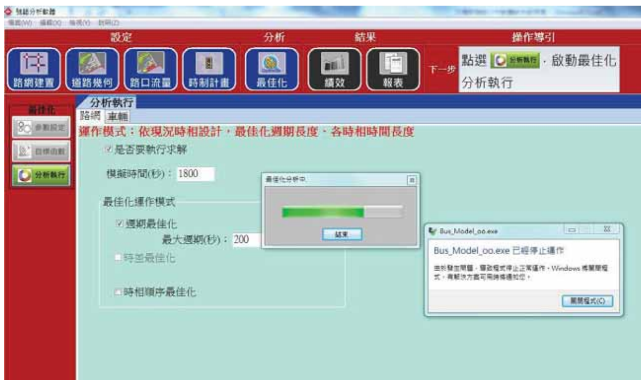
圖 3.1.5-3 交通部時制最佳化軟體使用限制-多路口最佳化運算時程式出錯
