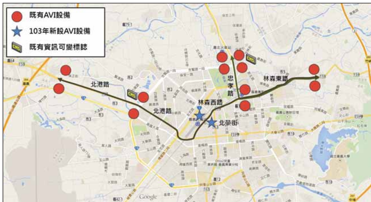
圖 4.1.2-1 AVI 位置及旅行時間資訊串接整合示意圖
