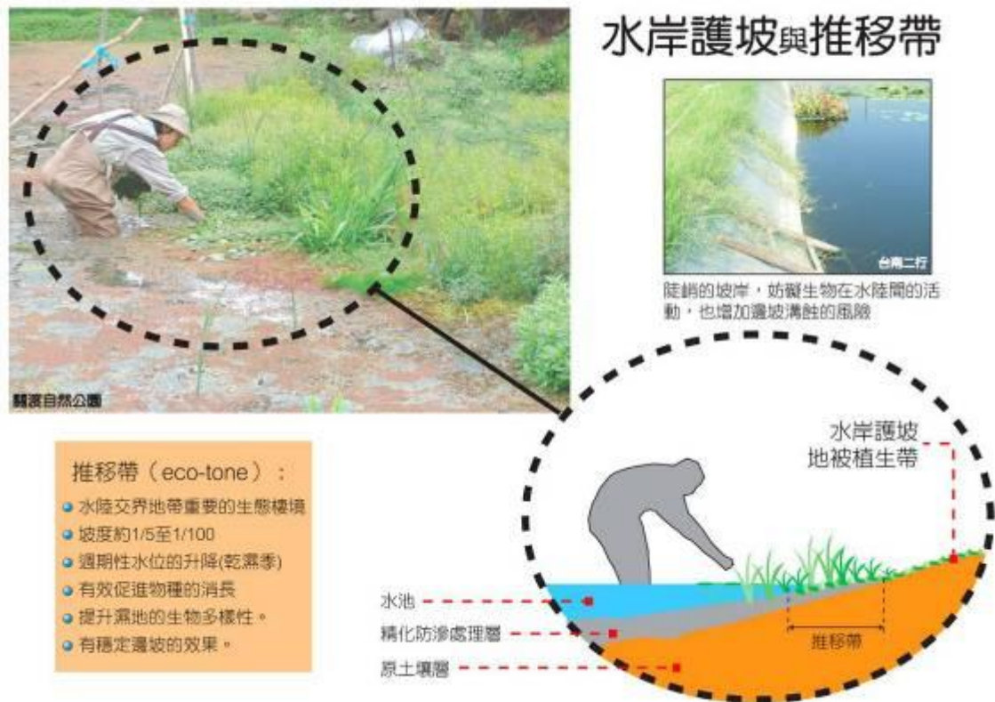
圖 7.5-2 人工溼地水岸植生護坡工法示意圖
