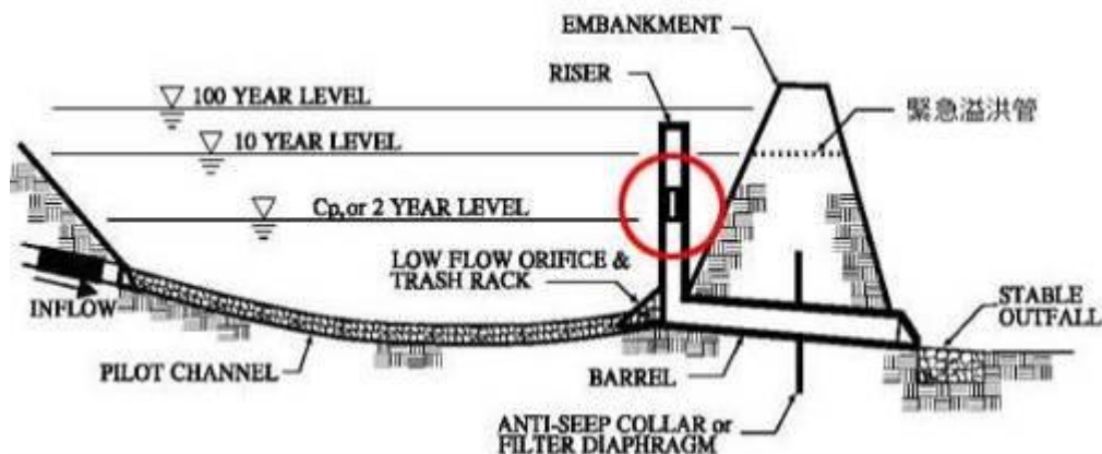
圖 7.3-2 防洪措施及設備示意圖
