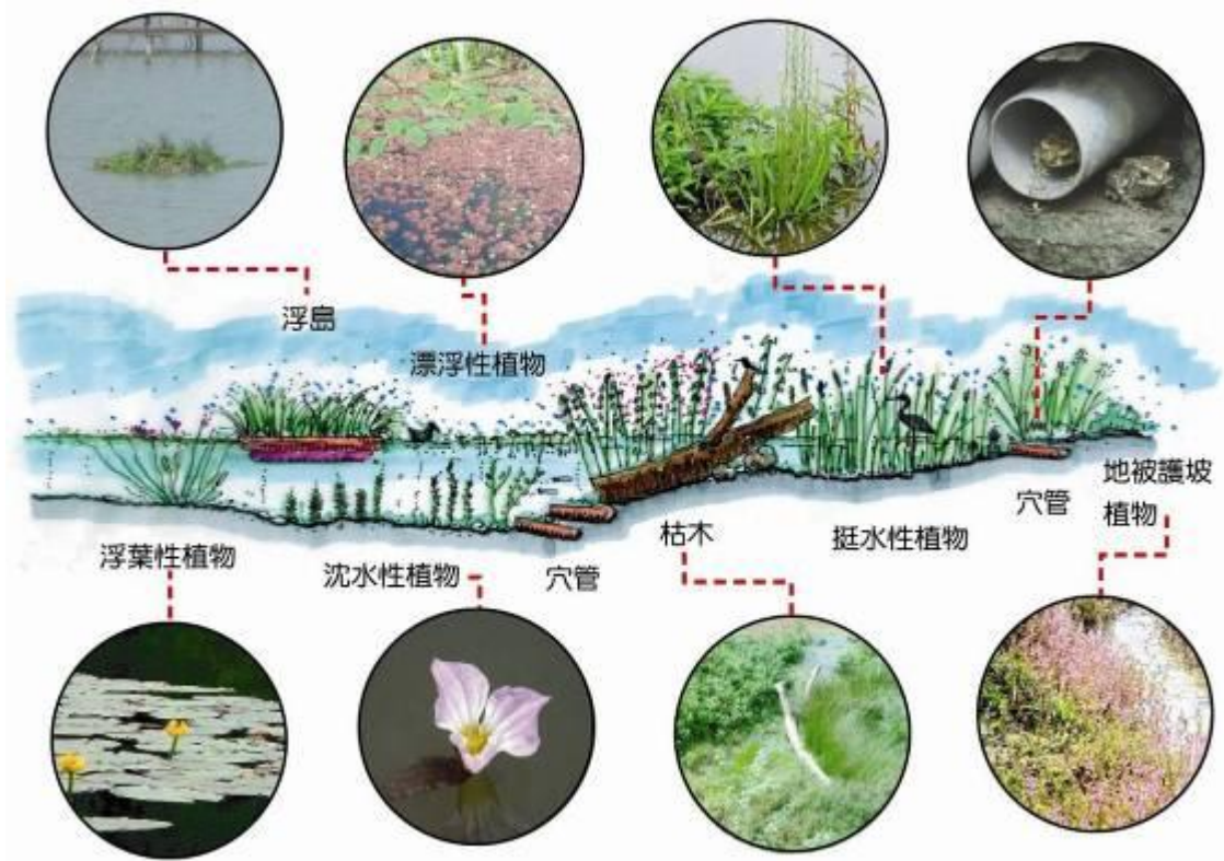
圖 7.5-4 多孔隙空間營造與水域植生搭配應用示意圖
