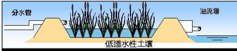
圖 6.1-3、濕地處理自然淨化法-自由水面系統示意圖
