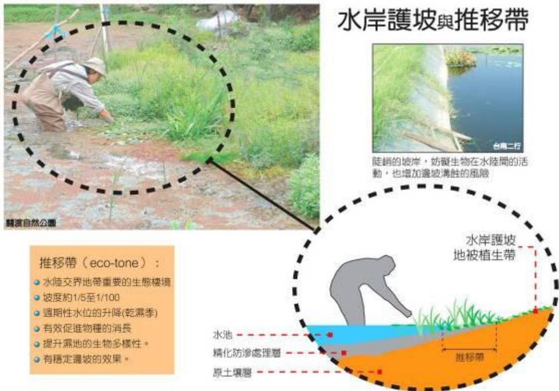
圖 7.5-2 人工溼地水岸植生護坡工法示意圖
