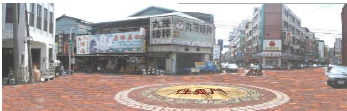
圖 7-2-5 具城門意象 logo 之鋪面示意圖 設置大面積高抗壓紅磚（陶磚）、花崗岩及鑄銅混合材質之城門意象鋪面 設計範圍內設置城門意象鋪面，考量施作時間及經費可編入後續工程
