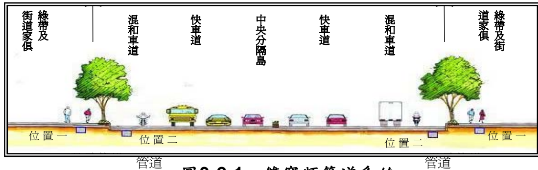
圖3-2-1 雙寬頻管道系統
