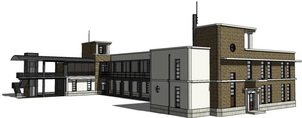
【圖 5-4】原嘉義電信局修復再利用模擬圖 增加鋼鐵構架以因應機能需求（李俊華繪 2008）
