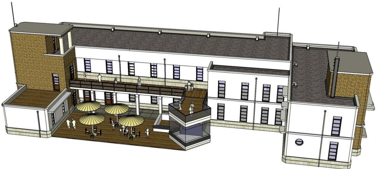
【圖 5-9】原嘉義電信局修復再利用模擬圖 增加鋼構玻璃空間及停車地下化保留廣場功能（李俊華繪 2008）
