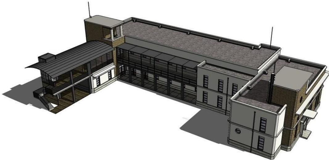
【圖 5-5】原嘉義電信局修復再利用模擬圖 增加鋼鐵構架以因應機能需求（李俊華繪 2008）
